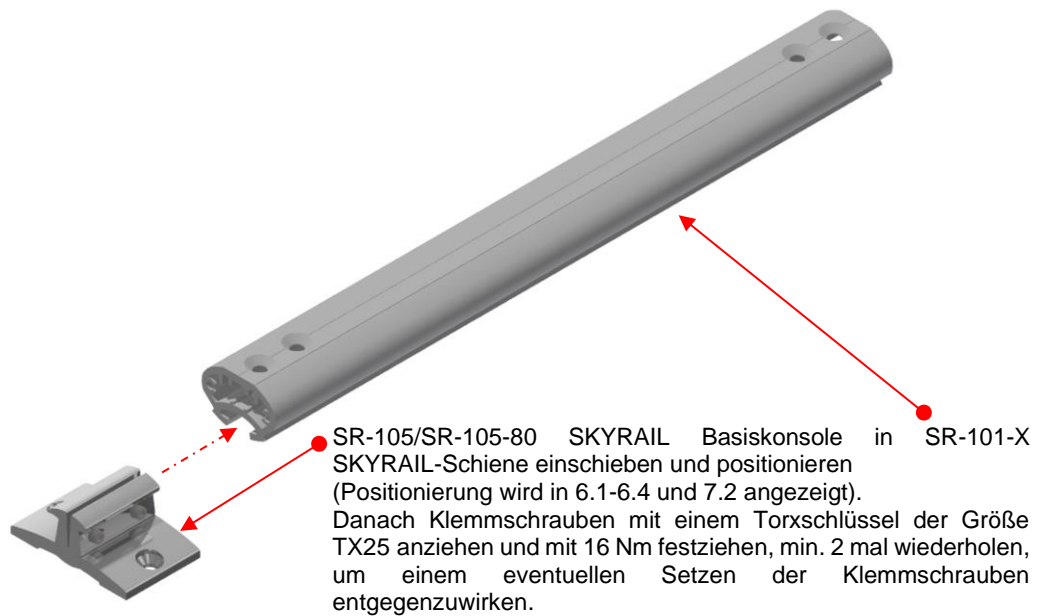
Abb. 1 Montage Basiskonsole SR-105
