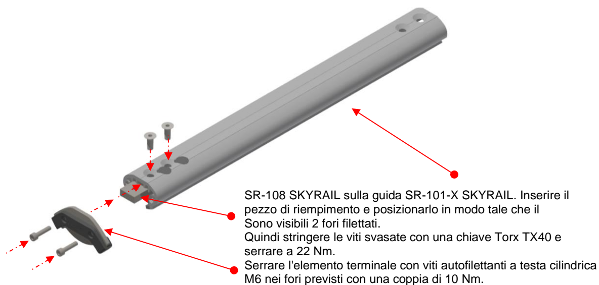
Fig. 3 Montaggio del tappo terminale SR-108
